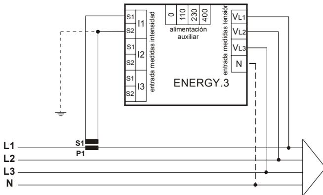
En la línea con 3 hilos (sin Neutro o con Neutro no distribuido) el terminal N no debe estar conectado.
