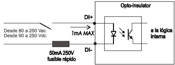
Es mejor poner un fusible (50mA 250 V fast) en la entrada digital. La máxima intensidad absorbida es 1 mA.
