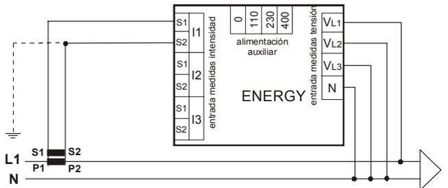
N.B. Si los multímetros son usados en líneas monofásicas, las medidas se refieren a la fase L1. Los demás datos mostrados relativos al sistema trifásico no deben considerarse.
