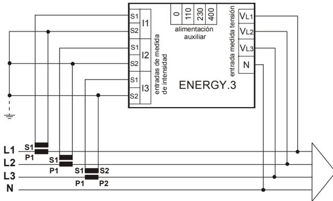
En línea con 3 hilos (sin Neutro o con Neutro no distribuido) el terminal N no debe estar conectado
