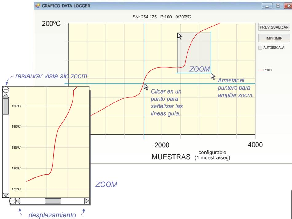
Para descargar a pantalla los datos registrados en el módulo.
